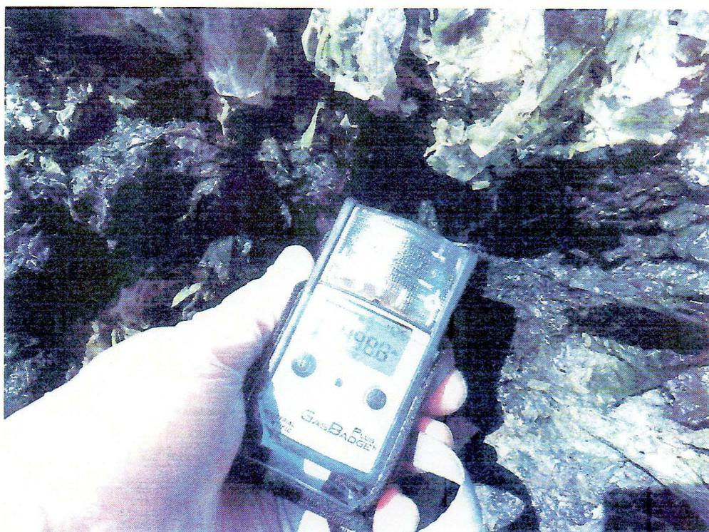
D'autres trous sont creusés dans la couche d'algues en décomposition, toujours aléatoirement, et l'appareil détecte à chaque fois du gaz H<sub>2</sub>S.
